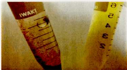
右は有毒な六価クロムの溶液。柿渋と10分間混ぜると、左のようにクロムと結合し、色が消える。ろ過で除去できる。
