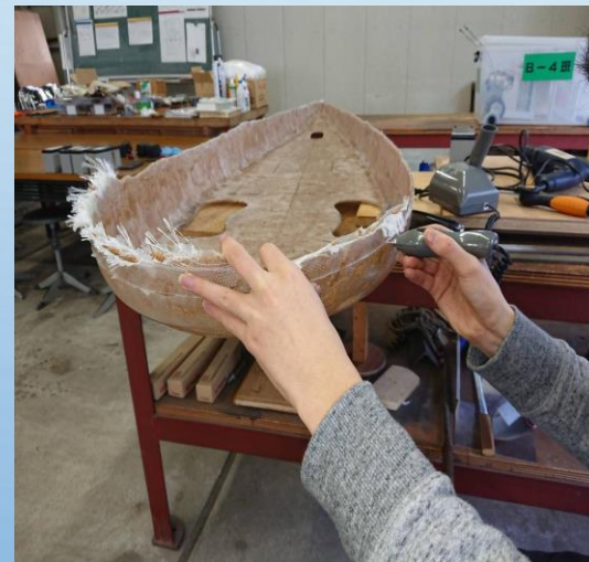
アンダーカウルの補修
