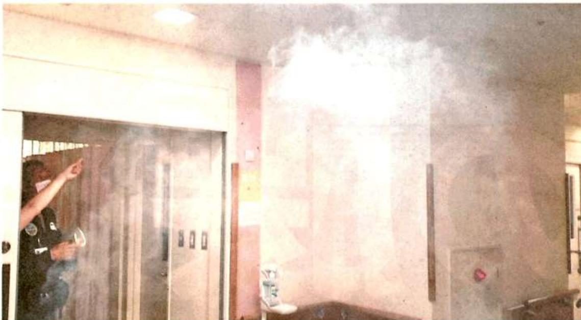
八戸市民病院で行われた、病室前の廊下で発生させた蒸気の換気状況を調べる実験（八戸工大提供）
