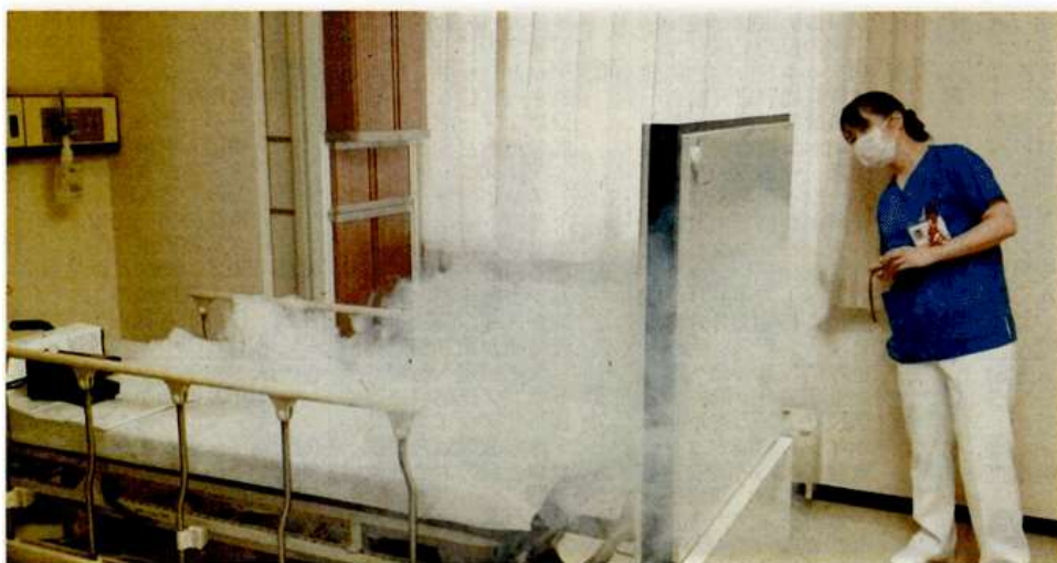
エーロゾルに見立てたスモークで拡散ルートなどを確認した実験 =9月上旬、八戸市立市民病院(浅川拓克准教授提供)
