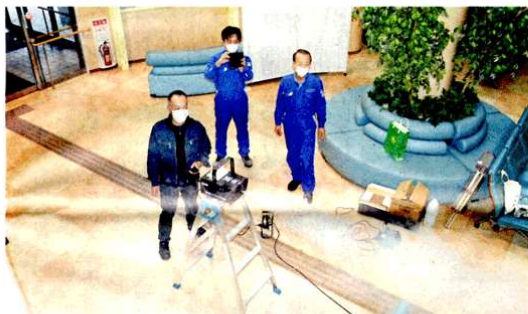
エーロゾルに見立てたスモークを発生させ、空調の状況を確認する浅川拓克准教授(左)ら=2020年10月、おいらせ町
